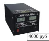
Входное напряжение 220V ~ 50 Hz Выходное напряжение  $0...+30 \text{ B} \pm 2\%$ 0.1V Пупьсации выхода Выходной ток, пот 15 A 450 W Мощность нагрузки, тах Изоляция ВХОД-ВЫХОД 2500V
